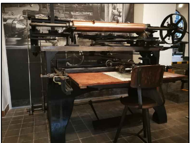
4.) PANTOGRAF (2180x1570mm, v. 1530mm) volně postaveno na podlaze, bez kotvení
