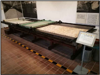
1.) STŮL NA PLOCHÝ FILMTISK (5200x1830mm, v. 790mm) volně postaveno na podlaze, bez kotvení
