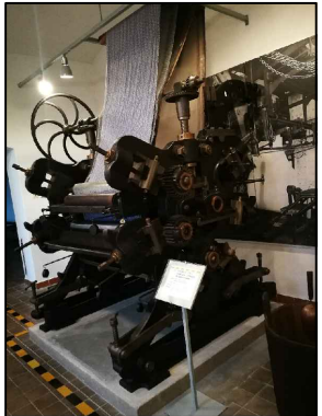
2.) VÁLCOVACÍ POTISKOVACÍ STROJ (2500x2250mm, v. 3100mm) nejtěžší stroj v expozici, stroj osazen a přikotven na nový betonový celoplošný podklad / základ, válce nad strojem je nutné zavěsit ze stropu a přikotvit k nové příčce ocelovým rámem
